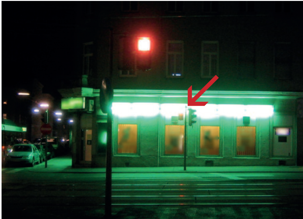
Abb. 45: Beispiel für die Beeinträchtigung der Verkehrssicherheit: Überstrahlung einer Fußgängerampel
