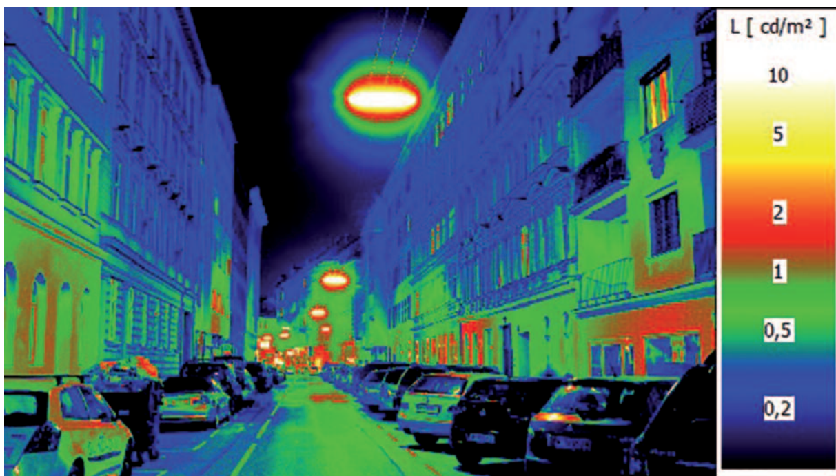
Abb. 32: Bisherige Beleuchtung einer Gasse in Wien mit Leuchtstofflampe
