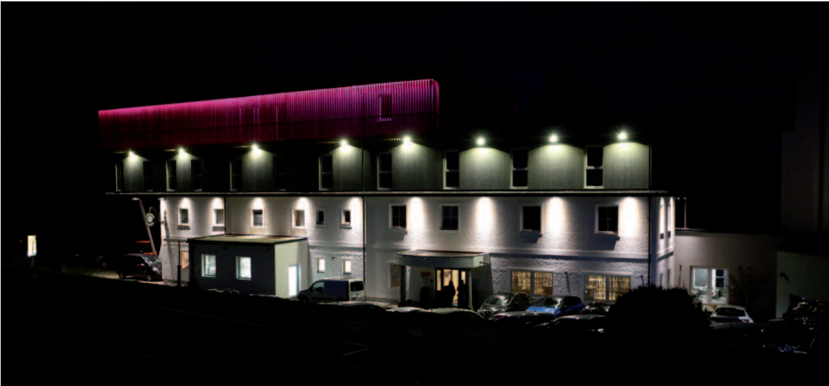
Abb. 46: Eine normgerechte Objektbeleuchtung ist in einer dunklen Umgebung sehr hell und somit für die optimale Wahrnehmung nicht erforderlich, Hotel Alpenblick, Kirchsschlag bei Linz
